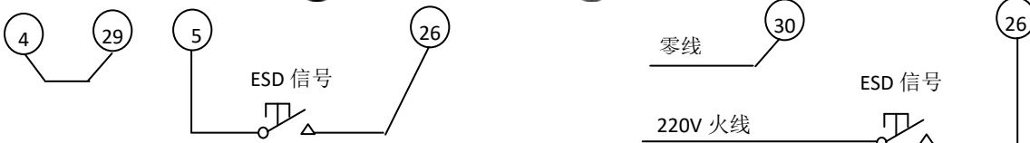
内部供电：ESD 控制外部接线
